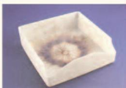
Venature da degradazione chimica, causata da un eccessivo tempo di permanenza del materiale nel cilindro.
